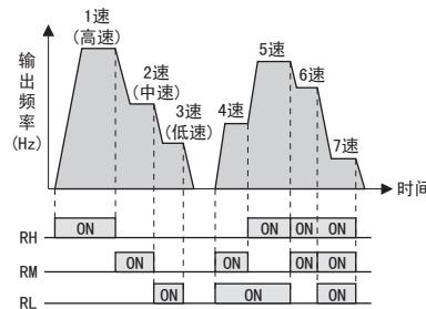
变更例 设定Pr. 4 多段速设定（高速）“40Hz”，合上端子RH, STF(STR)-SD进行试运转。
