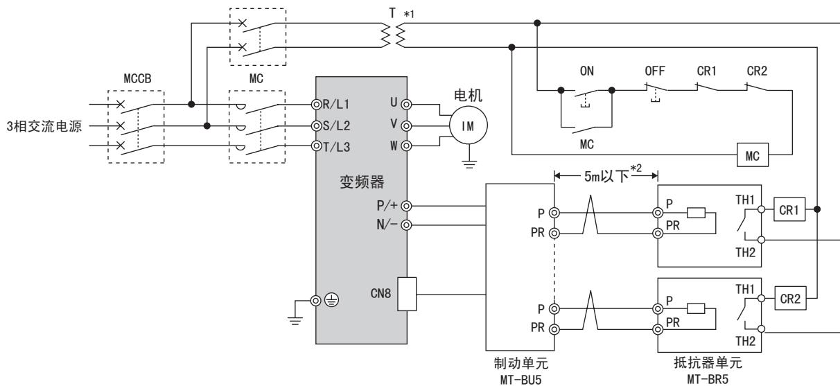
\*1 电源为400V等级的情况下请安装降压变压器。
