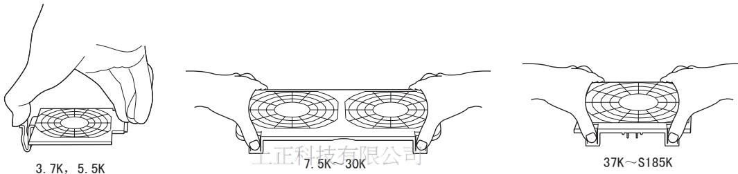
2) 拆下风扇连接线
