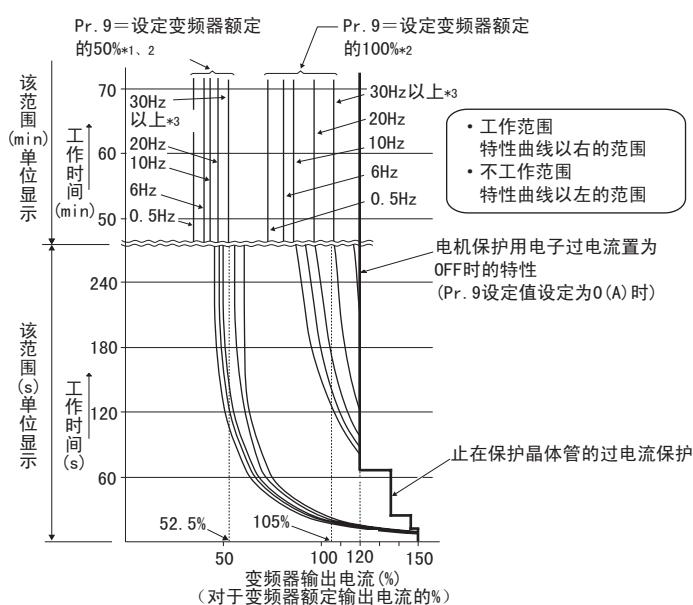
检测电机的过负载（过热），中止变频器输出晶体管的工作，停止输出。（工作特性如左图所示）
