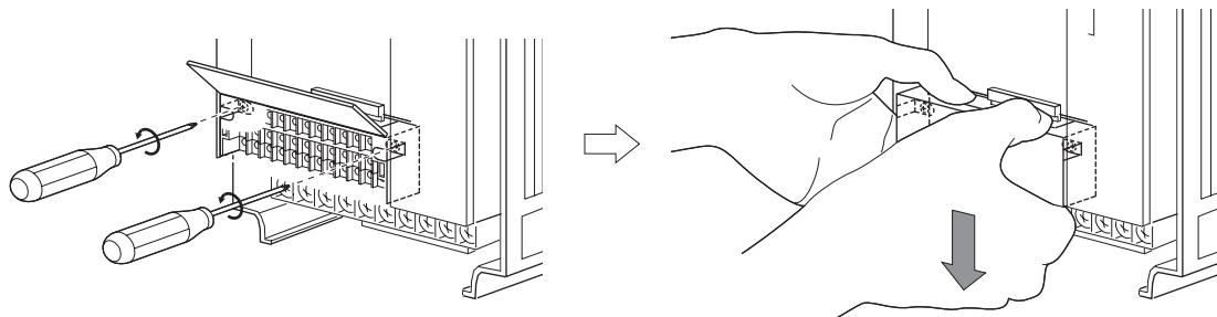
2) 将控制回路端子排里面的漏型逻辑 (SINK) 跳线接口切换为源型逻辑 (SOURCE) 来切换到源型逻辑模式。
