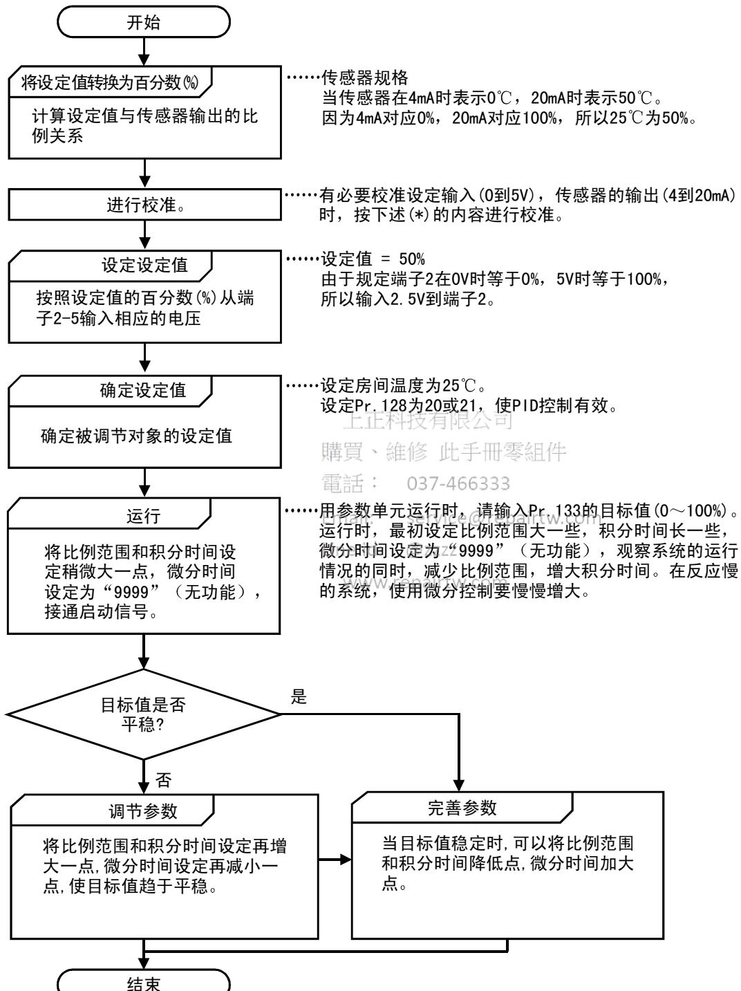
\*当需要校准时, →用Pr. 902及Pr. 903(端子2)或Pr. 904及Pr. 905(端子4)校正传感器的输出,
