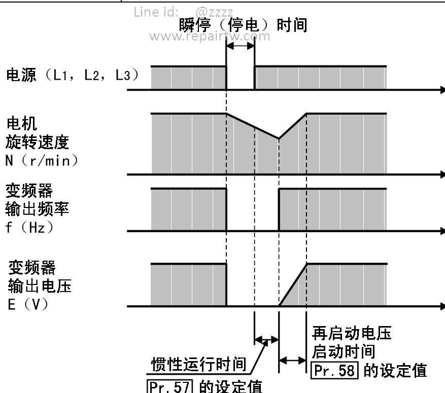
(注) 1. 瞬间停止再启动动作与电机的惯性运行速度无关，慢慢地提高输出电压，直到设定频率，为减电压启动方式。
