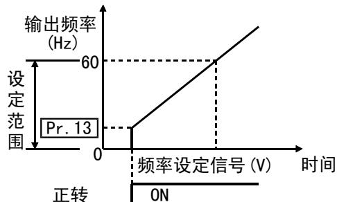
(注) 如果设定频率小于Pr. 13 “启动频率”的设定值，变频器将不能启动。
